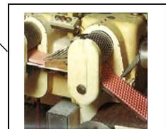
Mit hoher Geschwindigkeit versehen moderne Wickelmaschinen die einzelnen Bonbons mit einer Umhüllung in unterschiedlicher Größe und Form.
